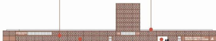
**Enveloppe:** prémurs préfabriqués (parement extérieur béton teinté dans la masse 70 mm + béton coulé en place: 190 mm + parement intérieur béton: 60 mm) + isolation polyuréthane; châssis vitré ouvrant caché en PVC plaxé deux faces avec fixation en tunnel.
