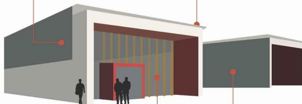
**Enveloppe :** façades à ossature bois + bardage métallique ; menuiseries extérieures en bois + protection solaire fixe par résille métallique ou bois.
